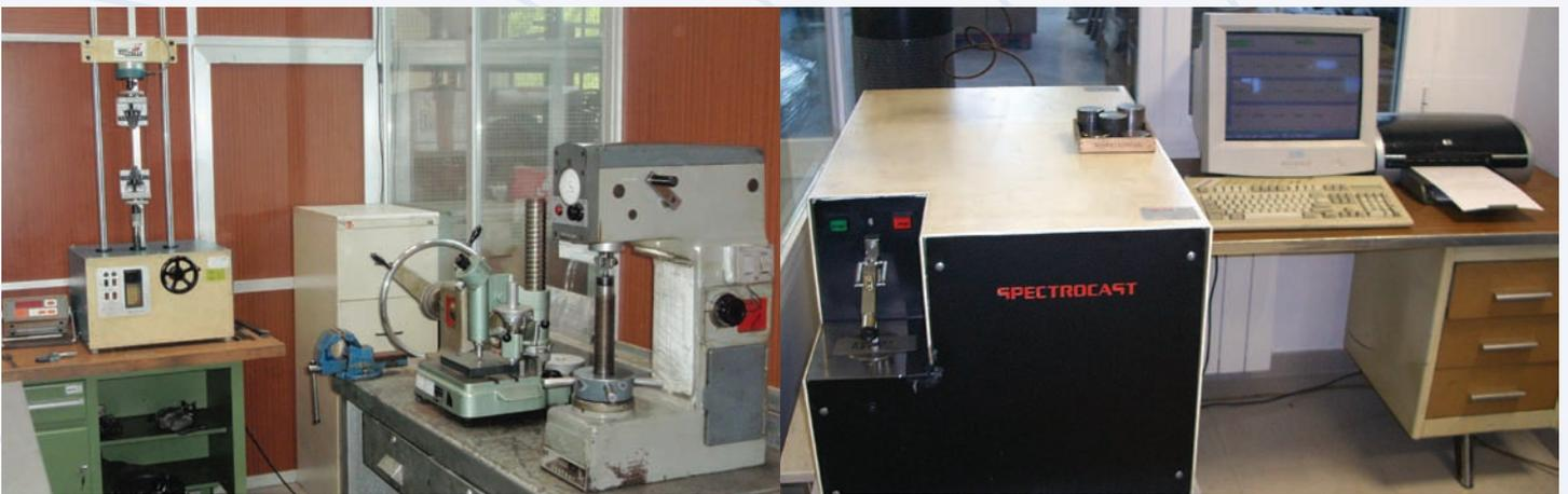
En su **laboratorio** se verifica todo el proceso de fabricación de sus productos y para ello cuenta con máquina de ensayo de tracción, espectrómetro, durómetros Rockwell y Vickers, ensayo de embutición, etc.
